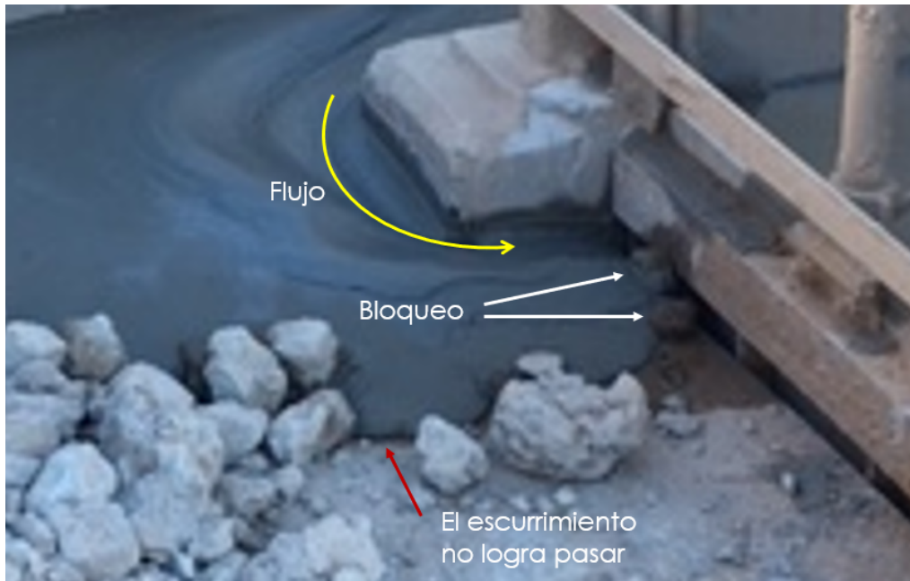
Figura 6: Las lamas remanentes después del rebalse muestran la naturaleza del fluido y cómo este no logra pasar entre pequeñas obstrucciones.
